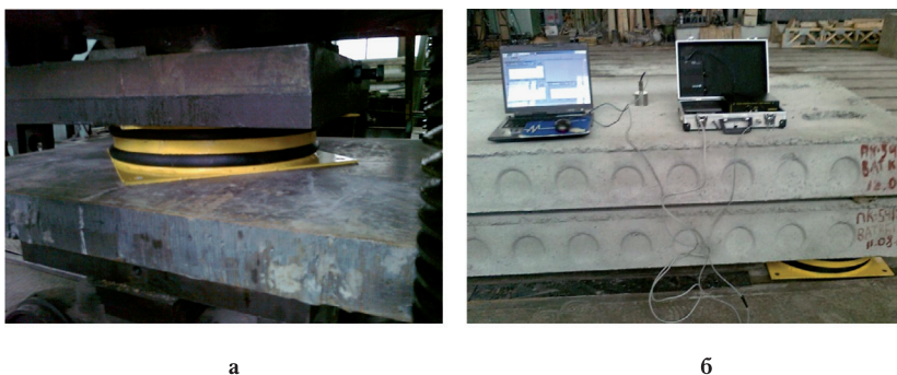
Рис. 5. Випробування гумометалевих сейсмоізолюючих блоків, проведені в ДП НДІБК: а) статичні випробування; б) динамічні випробування.
