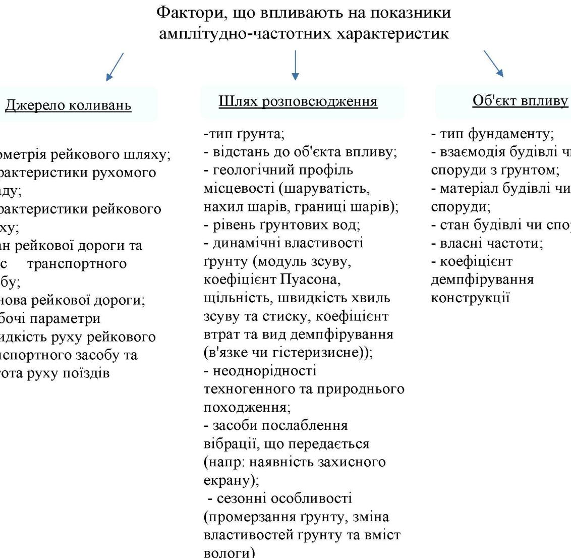
Рис. 1.8 Фактори, що впливають на амплітудно-частотні характеристики рухомого транспорту [11]
