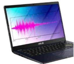
6. Програмне забезпечення: багатоканальна вимірювальна система «Сейсмомоніторинг» [71]. Призначена для запису сигналів, обробки даних та візуалізації результатів вимірювань. Використання програмного пакета забезпечує:
