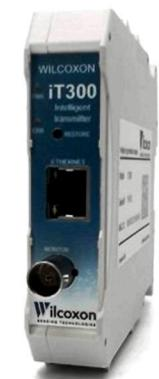
детектора, вхід температури та вихідну напругу датчика зміщення (BOV). Результати діапазону можуть бути відображені на пару аналогових виходів 4-20 мА, що дозволяє ряд унікальних варіантів обробки. Передає дані вимірювань на базову станцію за допомогою радіосигналу;
